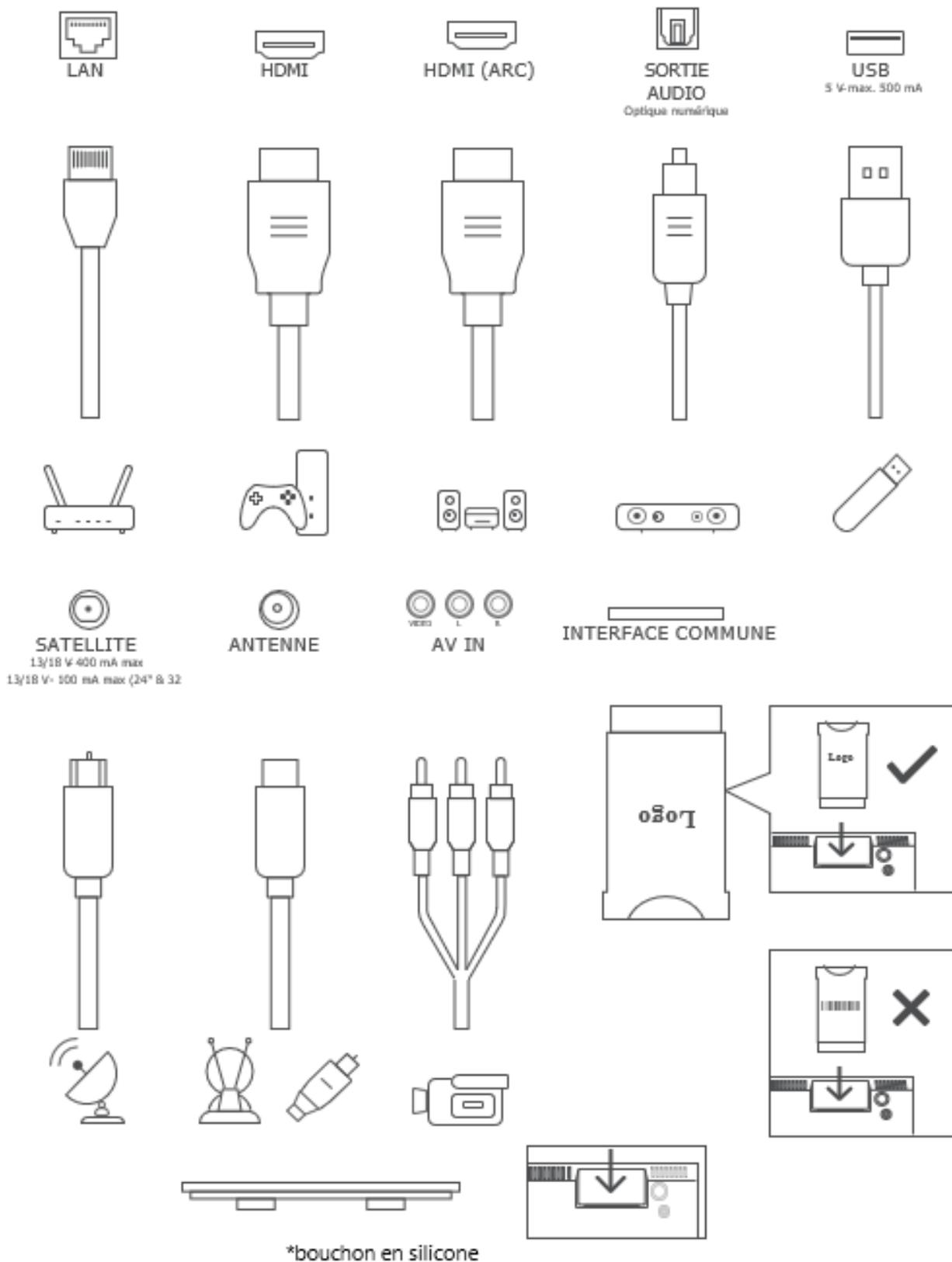
Remarque : si le modèle dispose d'un emplacement pour carte CI sur le dessus, un bouchon en silicone pour l'emplacement de la carte CI se trouve dans le sac d'accessoires (pour les modèles sans emplacement de carte CI, il n'y a pas de bouchon en silicone de ce type), veuillez insérer le bouchon en silicone dans l'emplacement lorsque la carte CI n'est pas utilisée.
