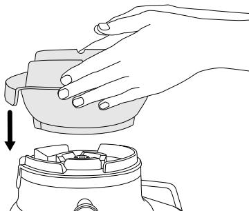
2. Allineare le frecce alla base del cestello filtrante in acciaio inossidabile con le frecce sul raccordo della base del motore e spingere verso il basso fino a udire uno scatto, per garantire l'aderenza alla base del motore.
