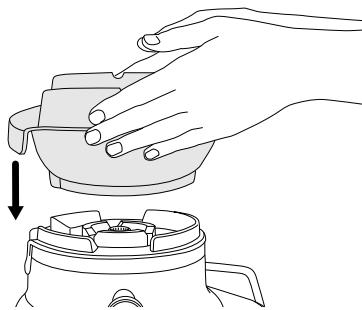
2. Alinea las flechas de la base del filtro de acero inoxidable con las flechas de acoplamiento del motor y empuja hacia abajo hasta que encaje en su sitio para crear un acople seguro con la base del aparato.
