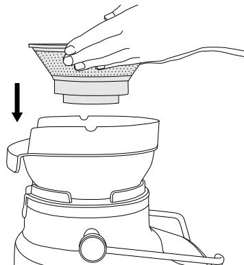
3. Placez le couvercle de l'extracteur sur le contenant du filtre, en plaçant la partie basse du goulot d'alimentation sur le panier-filtre en acier inoxydable.
