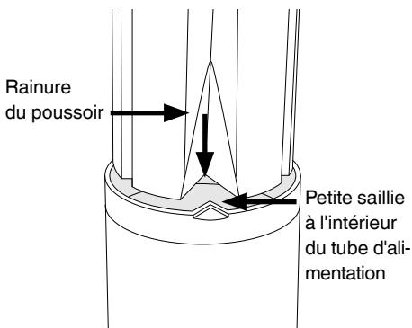
7. Mettez en place le récipient à pulpe en inclinant et soulevant légèrement la base du moteur. Insérez le récipient à pulpe sous le couvercle de l'extracteur à l'arrière, en vous assurant que le bord avant est inséré sous le rebord arrière du contenant du filtre et que le bord arrière est clipsé dans le fond de la base du moteur.
