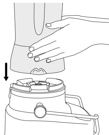
2. Relevez l'arceau de blocage de sûreté et placez-le dans les deux encoches situées de part et d'autre du blender.
