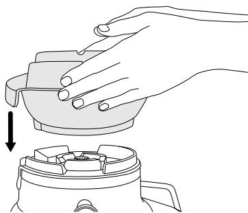
2. Alignez les flèches à la base du panier-filtre en acier inoxydable avec celles du couplage de la commande du moteur et poussez vers le bas jusqu'à ce que vous entendiez un déclic, afin que le tout soit bien fixé sur la base du moteur.
