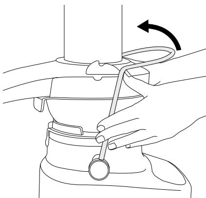
5. L'arceau de blocage de sûreté devrait maintenant être en position verticale et verrouillé sur le couvercle de l'extracteur.
