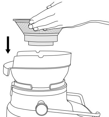
3. Coloque a cobertura do liquidificador sobre a taça do filtro, posicionando a parte inferior da calha de alimentação sobre o cesto do filtro de aço inoxidável.
