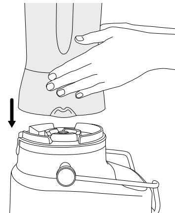
2. Heben Sie den Schutzriegel an und schieben Sie ihn in die Rillen zu beiden Seiten des Mixers.
