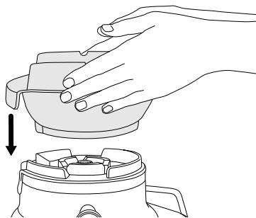
2. Alinhe as setas na base do cesto do filtro de aço inoxidável com as setas no acoplamento da transmissão do motor e empurre para baixo até encaixar no lugar para criar um ajuste seguro com a base do motor.
