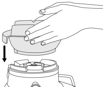
2. Richten Sie die Pfeile an der Unterseite des Siebeinsatzes mit den Pfeilen an der Antriebskupplung des Motorsockels aus und drücken Sie den Einsatz nach unten, bis er einrastet, um ihn sicher mit dem Motorsockel zu verbinden.
