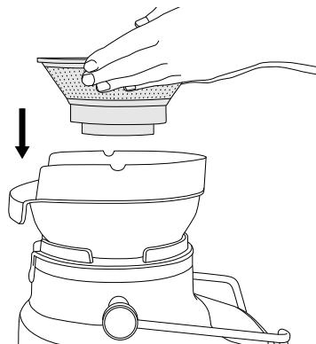
3. Plaats het deksel van de sapcentrifuge over de behuizing van de filterkom. Schuif de onderkant van de vultrechter over de filtermand van roestvrij staal.
