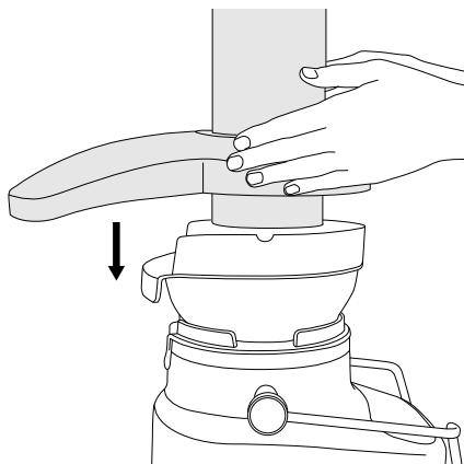
4. Relevez l'arceau de blocage de sûreté et placez-le dans les deux encoches situées de part et d'autre du couvercle.
