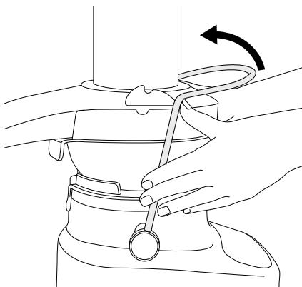
5. La leva del blocco di sicurezza dovrebbe adesso trovarsi in posizione verticale ed essere fissata alla parte superiore del coperchio dello spremitore.
