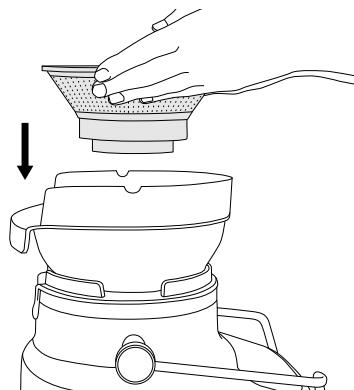
3. Allineare il coperchio dello spremitore con la copertura del filtro, posizionando la parte inferiore dell'imbuto sopra il cestello filtrante in acciaio inossidabile.
