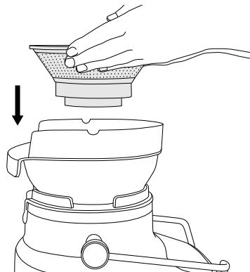
3. Setzen Sie den Deckel des Entsafters auf die Einfassung des Siebeinsatzes und positionieren Sie den unteren Teil des Einfüllschachts so, dass er auf dem Siebeinsatz aus Edelstahl aufsitzt.
