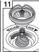
11 Oberen Kegel fest einschieben
