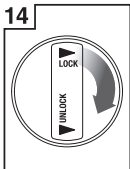
14 Bohnenbehälter einrasten lassen
