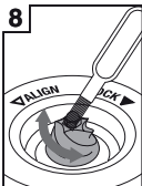
8 Pulire la macina inferiore con una spazzola per la pulizia
