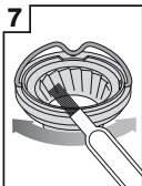
7 Pulire la macina superiore con una spazzola per la pulizia
